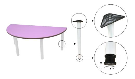
Mesa de adulto semiredonda, compuesta por cuatro patas de tubo metálico de Ø60 x 1,5 mm con acabado en pintura Epoxi y una tapa en tablero MDF laminado de 21 mm de espesor, con cantos redondeados y superficie y contratiro de laminado de alta presión (HPL).
